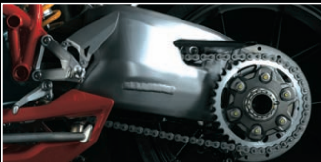
Forcellone monobraccio rigido, alleggerito, dalla tecnica di costruzione unica con fusioni singole ed elementi realizzati in alluminio altoresistenziale. / Lightweight, rigid, single-sided swingarm with unique cast/fabricated manufacturing technique.
