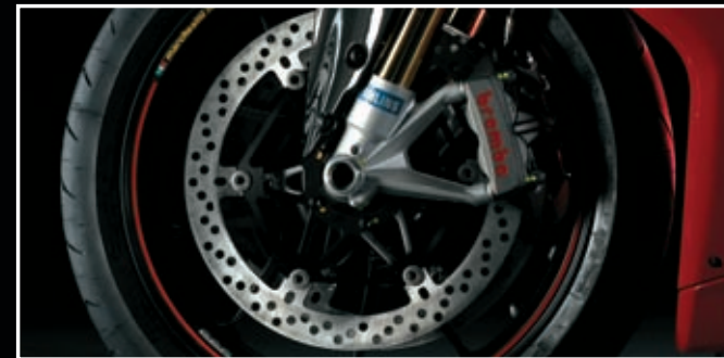
Cerchi Marchesini in lega leggera con razze a Y, proposti in alluminio forgiato e lavorato di macchina nella versione 'S'. / Lightweight Marchesini Y-shaped spoke wheels are machine finished forged-aluminium on the 'S' version.
