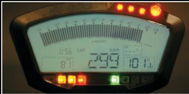
La strumentazione da MotoGP, derivata direttamente dalla Desmosedici GP7, è comandata da un blocchetto elettrico sul manubrio. / MotoGP instrumentation, taken directly from the Desmosedici GP7, is handlebar switch-gear controlled.
